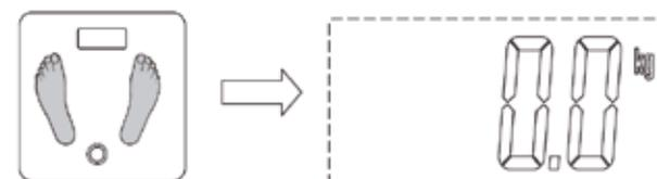
3) Pararse y los datos de peso se bloquearán automáticamente parpadeando dos veces.
