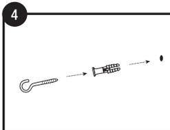
4 En la pared opuesta, a la altura del tendedero, haga un agujero, coloque el anclaje de goma y posteriormente introduzca el clavo "gancho".
