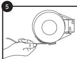
5 Tire de la cuerda hacia el gancho y, a continuación, enróllelo alrededor de la lengüeta situada en la parte inferior de la base para tensar la cuerda.
