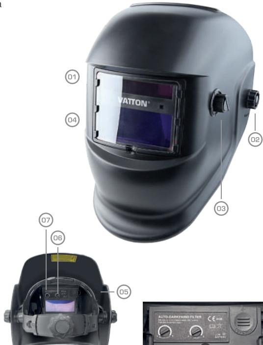
**Regulação da sensibilidade do interruptor:** O operador pode regular a quantidade de luz necessária para escurecer a lente, em função das condições de trabalho. Reduzir a sensibilidade para evitar interferências. Quando se trabalha com um pequeno arco elétrico, é necessária uma sensibilidade elevada.
