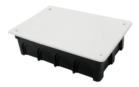
Caja empalmes onlex, tapa con tornillos. Empotrable en instalaciones de interior. Laterales de fácil apertura para tubos. Material termoplástico libre de halógenos. Resistente al hilo incasdescente 650°. Temperatura de instalación: -5°C a +60°C. Tensión no superior a 1000V c.a / 1500V c.c. Fabricada según Norma UNE 60670-1:2006. Conformidad CE según Directiva 2014/35/UE.
